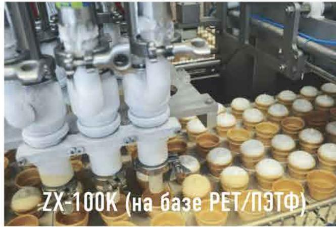
Различные втулки из ZX-100K используются в дозаторах на машинах по производству мороженого. Ранее применяемый материал PTFE был заменён как в некоторых узлах насоса, так и в открытии дозирующего вентиля. Благодаря низкому износу был увеличен срок службы и сокращены затраты.
