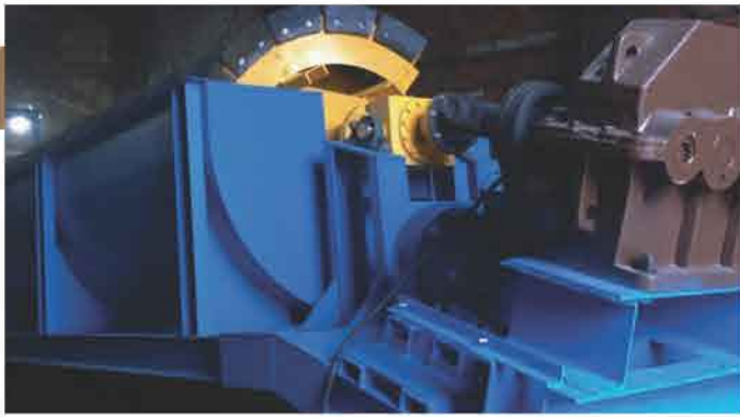
Детали из материала ZH-100K в спиральных классификаторах. Футеровка питателей и грохотов материалами INKULEN PE и INKUMER EL.
