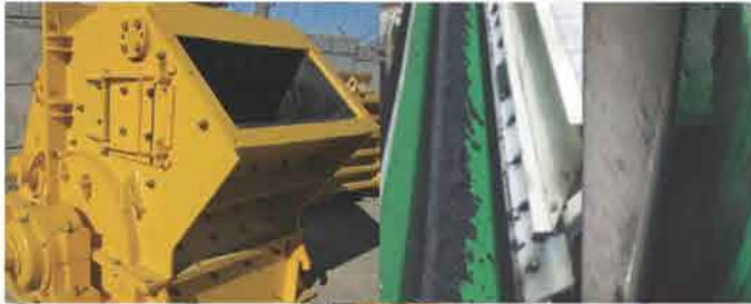
Детали из материала ZH-100K в спиральных классификаторах. Футеровка питателей и грохотов материалами INKULEN PE и INKUMER EL.
